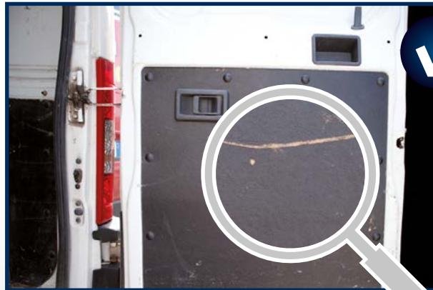
NORMALE USURA: pannello rivestimento porta carico in buono stato.
