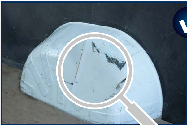
NORMALE USURA: vano di carico con passaruote in normali condizioni d'uso.
